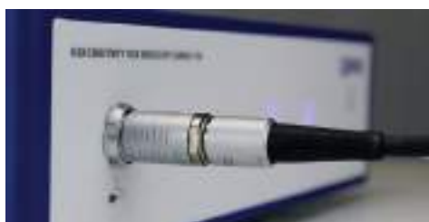
Connexion de la tête de caméra 1156
